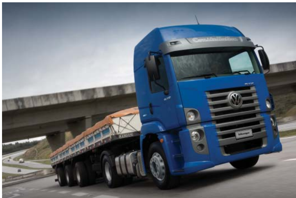
Linha VW Constellation tanto tem motor MAN, à base de EGR, quanto Cummins, com SCR
