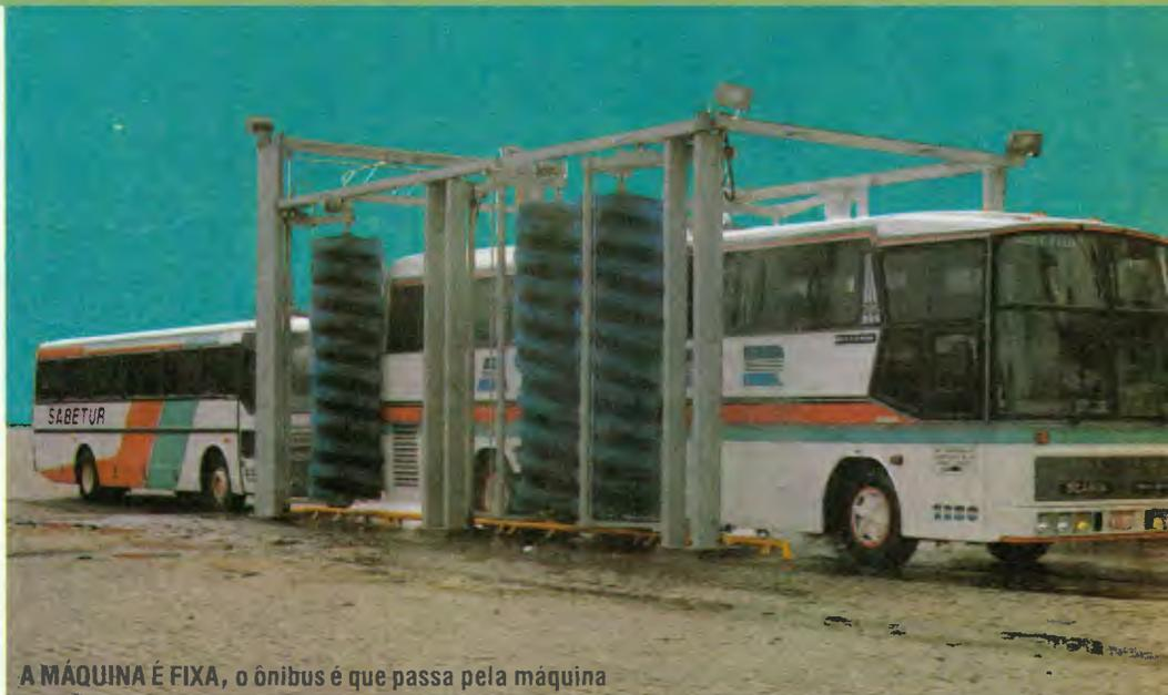
A MÁQUINA É FIXA, o ônibus é que passa pela máquina
