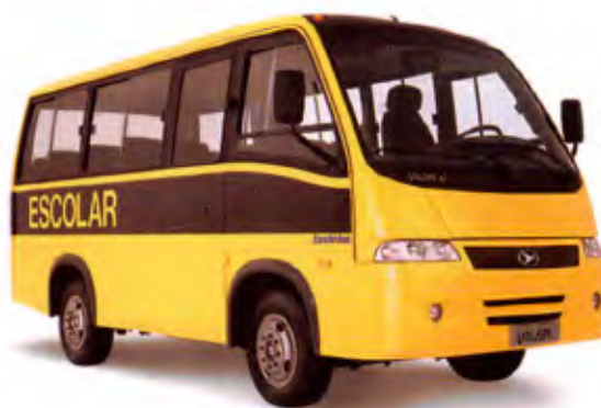
A carroceria possui barras de proteção laterais e para-choques dimensionados para absorção de impactos
