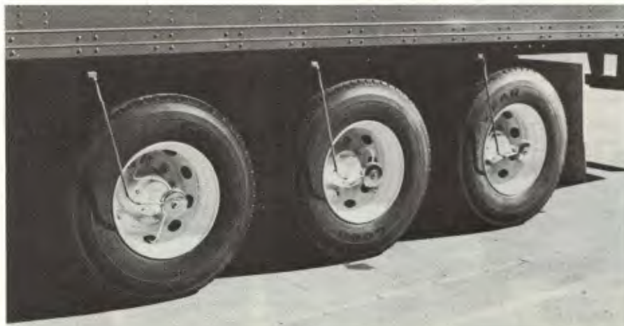
Criada para radiais sem câmara, a roda “drop center” aumenta a vida do pneu
