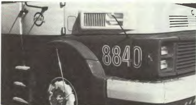
Etsul usa rodas “drop center” em caminhões Mercedes e Volvo
