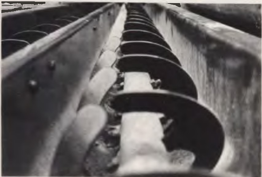
Rôscas: mais adequadas para transporte de granulados não corrosivos.
