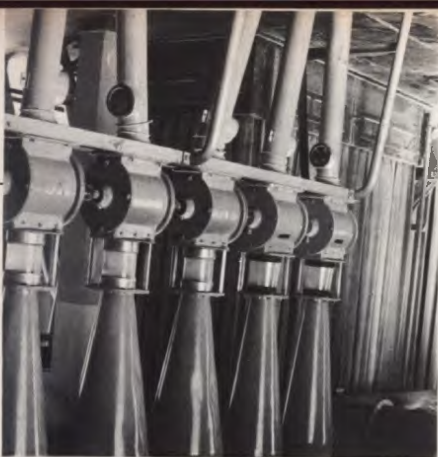
Pneumáticos: movimentam granéis, através do ar, em tubos fechados.
