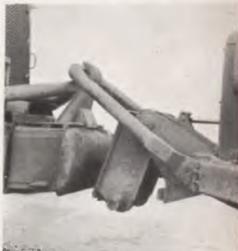
O engate entre dois motoscrapers amortece choques hidraulicamente.
