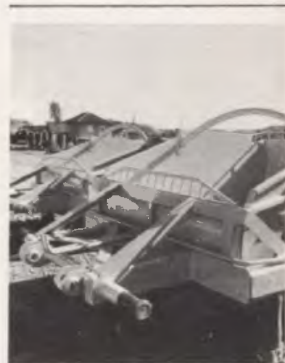
O trator do conjunto de scrapers em tandem é de rodas e tem 90 cv.
