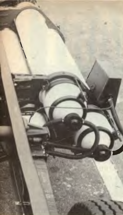
Segundo Ricardo Abreu, a MBB está trabalhando na redução de peso dos cilindros para permitir o aumento da autonomia dos ônibus, que era inicialmente de 280 km e agora já chega a 330 km
