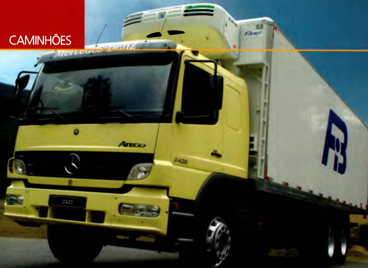
Atego 2425, com terceiro-eixo de fábrica, tem capacidade de carga útil de 16.570 kg e comprimento máximo de carroceria de 9,8 m
