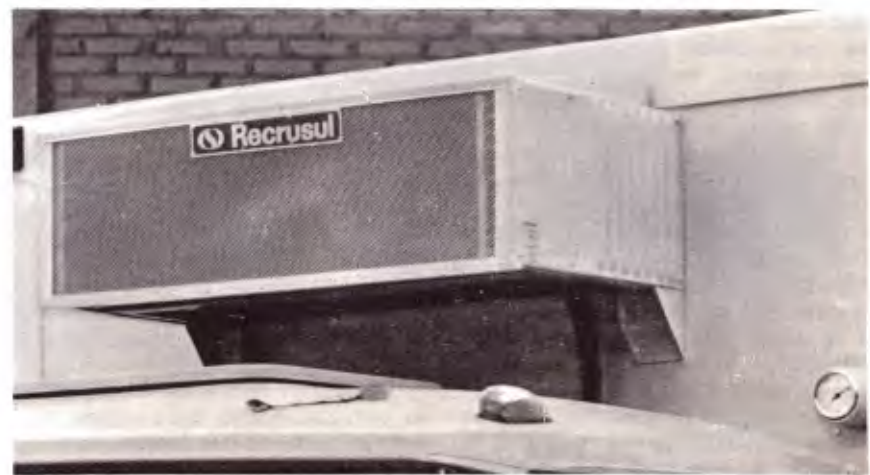
Equipamento de refrigeração 3606: acionamento hidráulico e elétrico.
