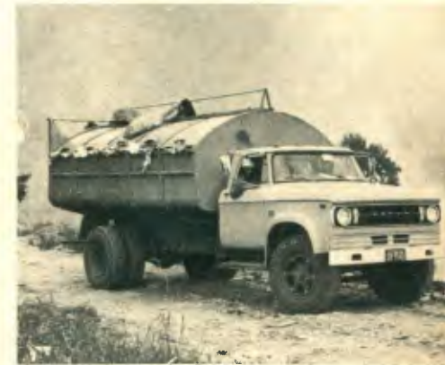
Grande parte do sucesso do caminhão semipesado D-950 da Chrysler pode ser creditada ao motor MWM, com seis cilindros em linha e 138 hp de potência. A maioria dos usuários ouvidos por TM não esconde sua satisfação com o veículo.
