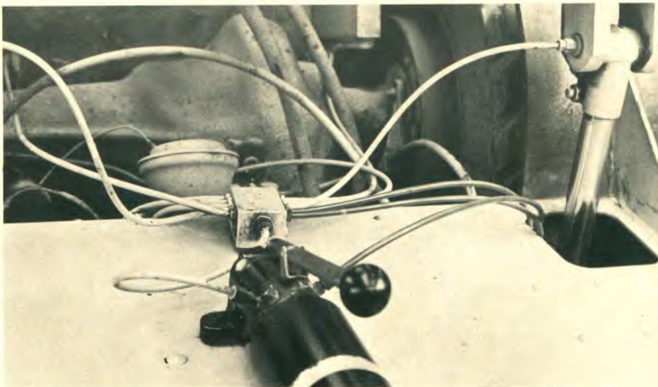
A lubrificação centralizada vem sendo utilizada por empresas que precisam reduzir o tempo de parada dos carros.
