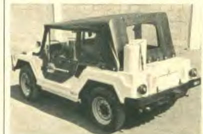
O X-12, versão civil do X-12M, tem motor Volkswagen de 1 584 cm 3 e 60 hp (SAE) a 4 600 rpm.
