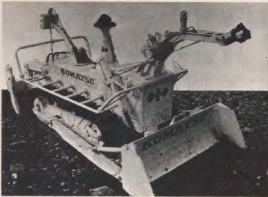
O bulldozer submarino opera em profundidades que variam de 2 a 60 metros
