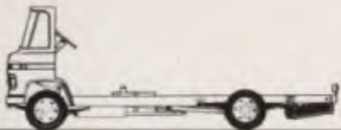
Chassi com meia cabina, para servir de base a micro-ônibus ou furgão integral. Distâncias entre-eixos de 2,95m, 3,50m e 4,10m.
