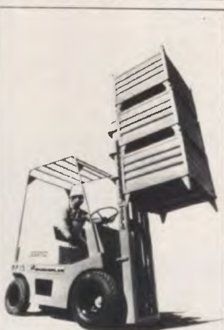
A MP 1.5, para 1,5 t, tem motor VW ou Agrale diesel.
