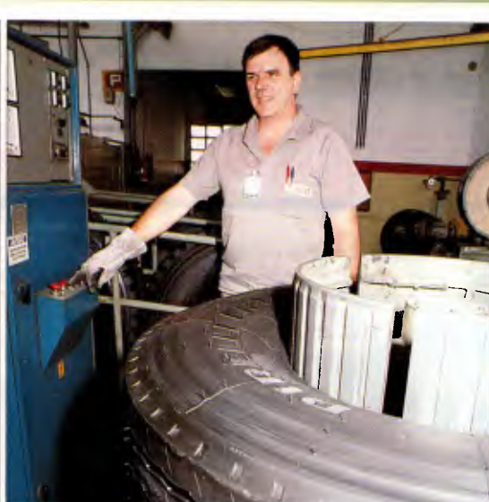
Fases da fabricação e controle final, onde se faz o balanceamento: tecnologia para garantir a qualidade dos pneus radiais
