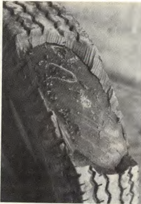
Ao estudar dezenove carcaças, o eng o Jorge constatou que a metade se perdeu por excesso de cortes nas laterais e bandas e muitos consertos
