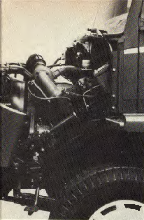
O capô basculável para frente facilita o acesso ao novo motor
