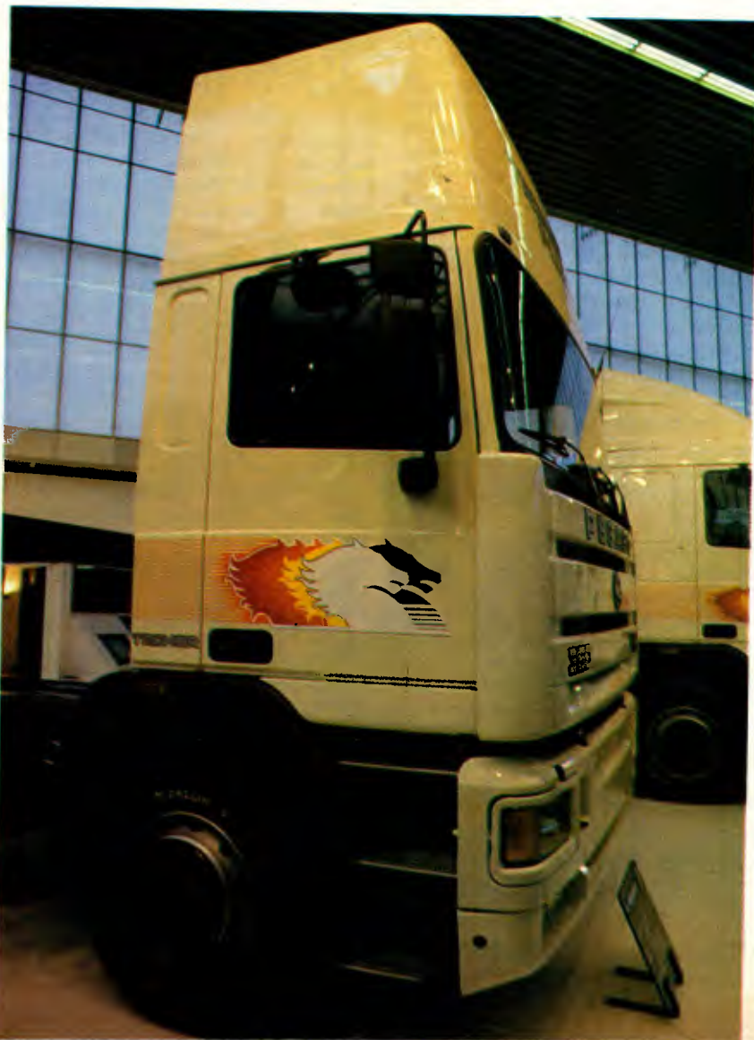
Harry Vos e Nedlloyd, duas transportadoras holandesas que usam o engate curto. A inovação roubou espaço das cabinas.
