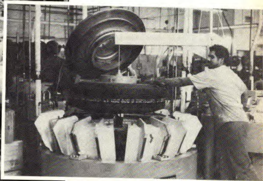
A escareação (à dir.) e a vulcanização (embaixo) dão novo perfil ao pneu usado
