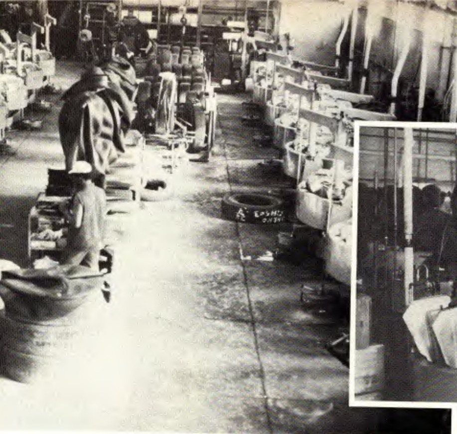
A escareação (à dir.) e a vulcanização (embaixo) dão novo perfil ao pneu usado
