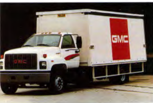
Para o transporte em curtas e médias distâncias, a GM oferece o GMC 11-170, com motor de 170 cv e pbt de 11 t
