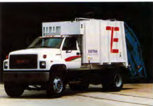
O médio 14-190, para operações urbanas como coleta de lixo, tem motor de 190cv e pbt de 14 t
