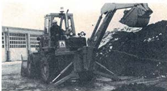
Retroescavadeira CM 650 acoplável nas carregadeiras 545 B e 605 B.
