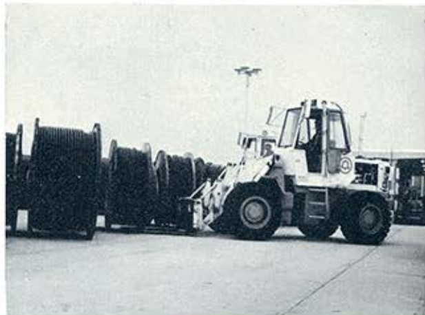
Colocar os rolos em ângulo evita choques na retirada.
