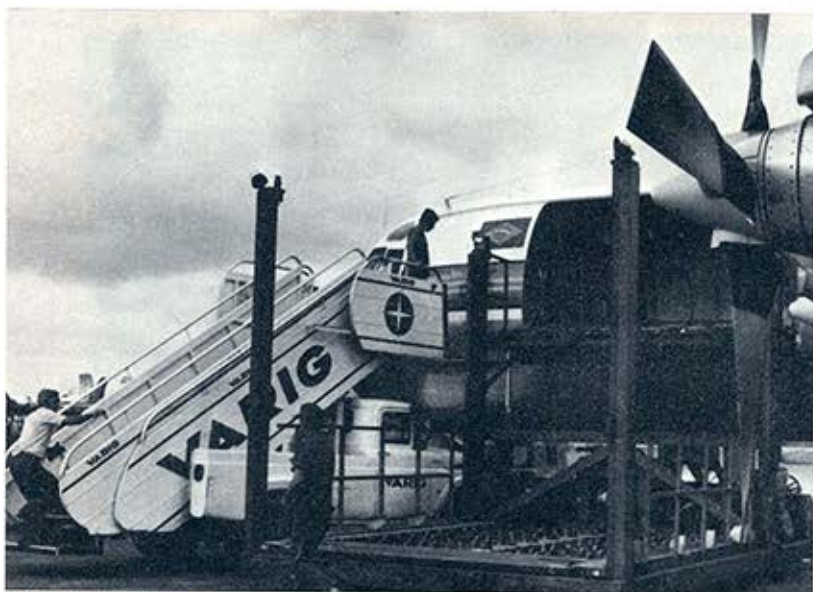
O loader é posto junto ao avião e preparado para receber o pallet montado.
