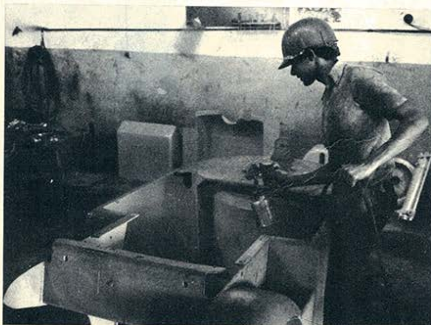
Antes de receber os componentes reparados, o chassi é pintado internamente.
