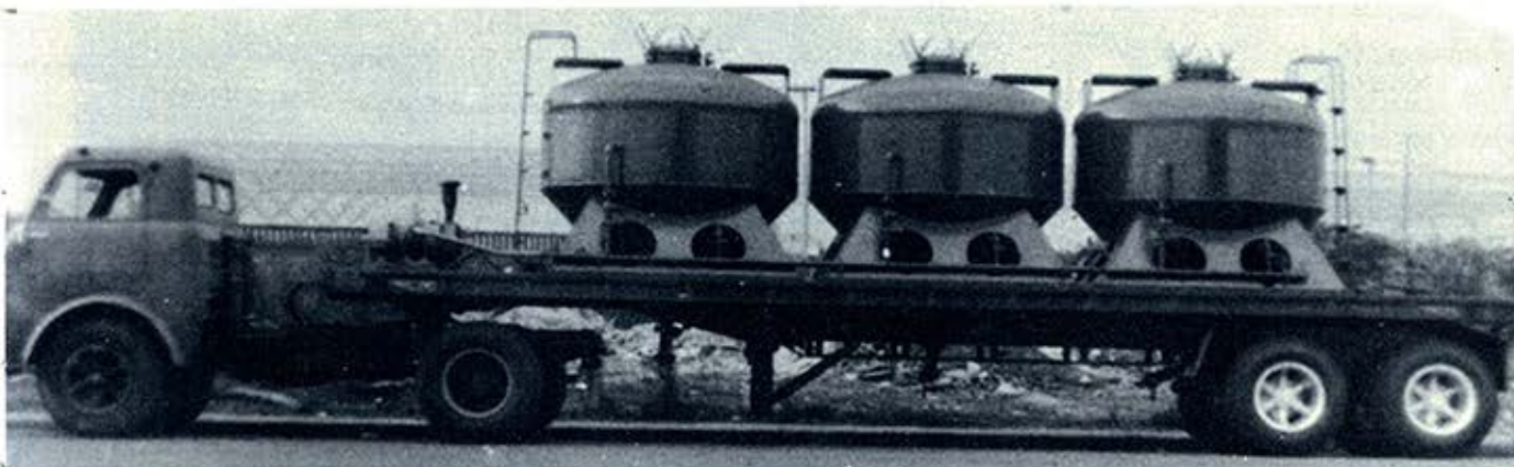
Cada "pêra" tem capacidade de carga de 6 t a 8 t e pode compor "baterias" de duas ou três unidades.
