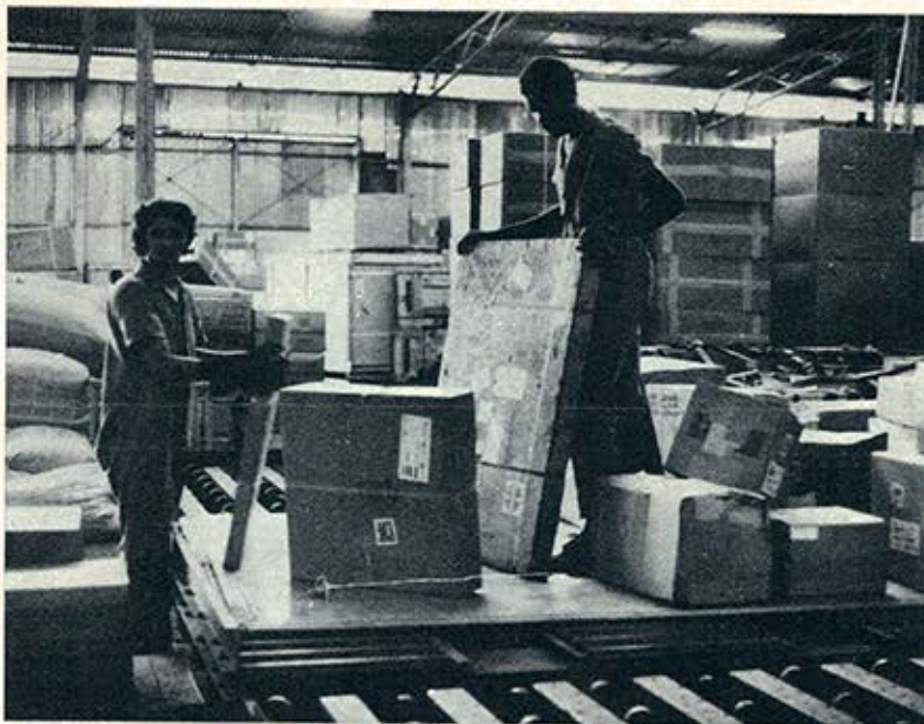
A primeira fase do processo de preparação é a montagem das cargas no pallet.
