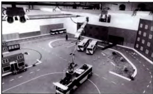
Percurso em miniatura ligado por computador a uma réplica de frente de ônibus
