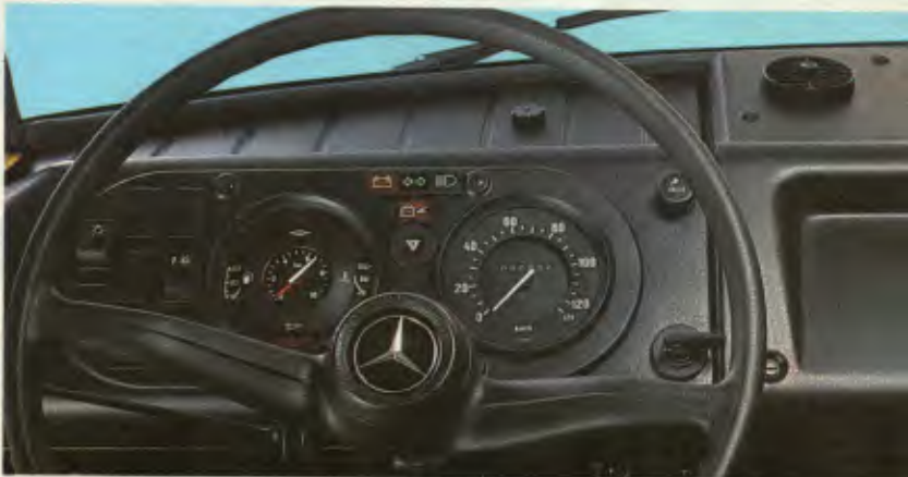
Novo painel, ainda mais funcional e completo. Partida com chave, retorno automático do pisca-pisca e temporizador do limpador de pára-brisa.
