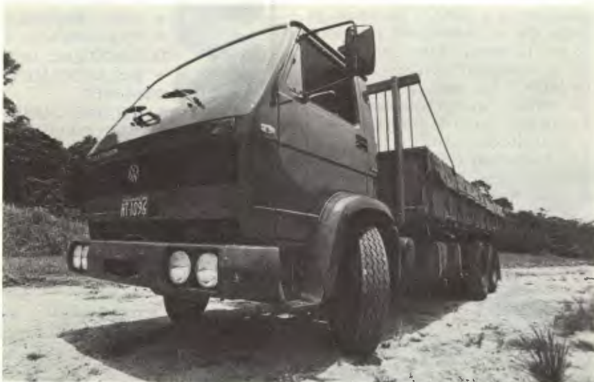
O novo 15-160 turbo, com terceiro eixo, ainda sem o número na cabine
