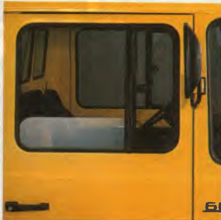
Janelas reprojctadas, com quebra-vento e novo sistema de acionamento vertical dos vidros.
