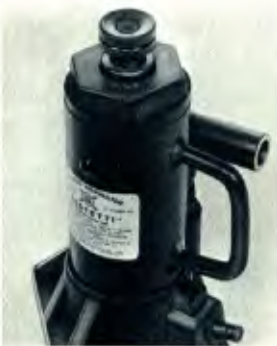
"Jacaré" e "garrafa", dois dos macacos hidráulicos.
