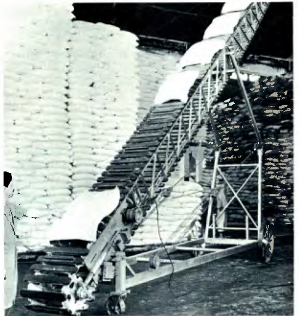
O equipamento desloca e empilha 1200 sacas/hora.
