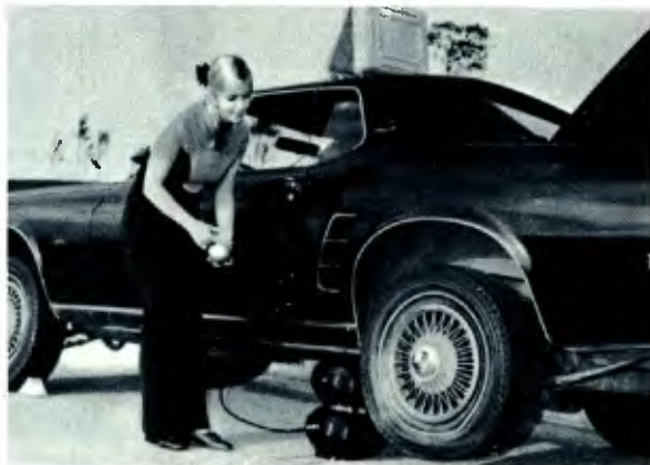
Alimentado pelo ar da esfera, o macaco eleva 1,3 t.
