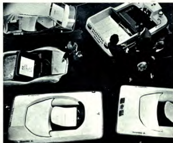
Todos os veículos são hidráulicos e em fibra de vidro.
