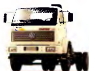
VW 14.150. Equipado com a transmissão FS-4205
