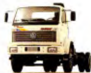
VW 14.170 BT. Equipado com a transmissão FS-4205
