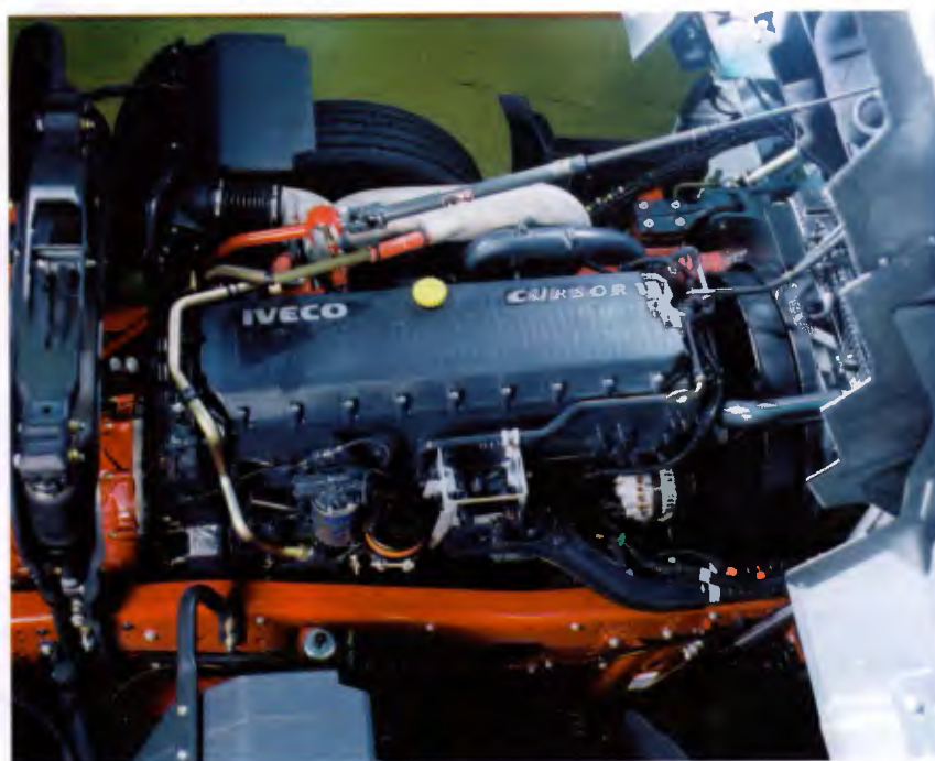
Motor eletrônico de 380 cv é adequado às normas do Conama fase 4
