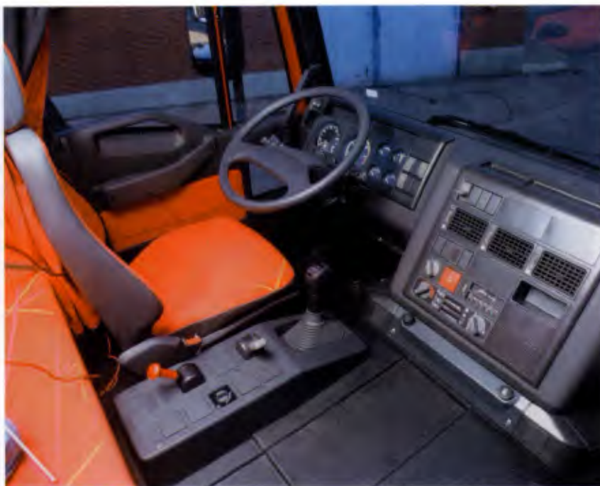
Interior: volante ajustável e banco do motorista com suspensão pneumática
