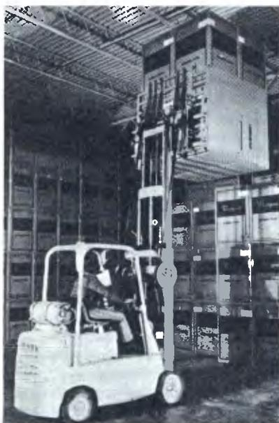
A fotografia acima mostra uma Garra Hidráulica p/ manusear caixas de papelão sem o uso de pallets. É apenas um dos vários tipos de acessórios fabricados pela CASCADE.
