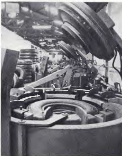
Molde de 6 partes (recape a quente)
