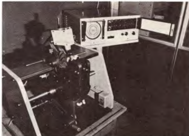
O balanceador de eixos elimina folgas radiais e axiais
