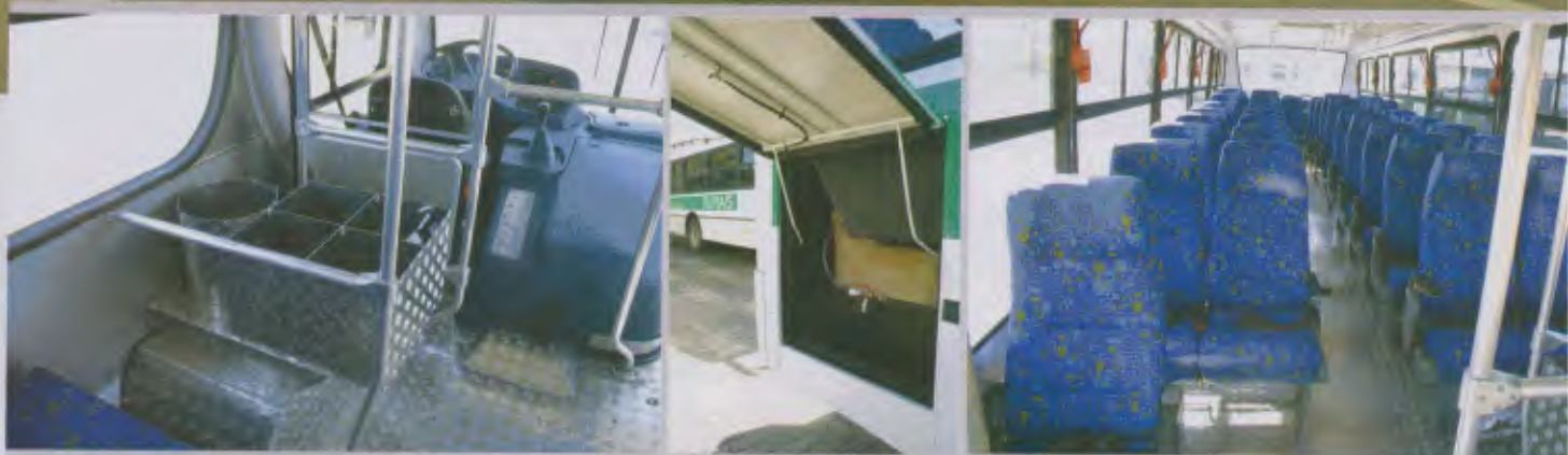
Os ônibus rurais, com chassis Mercedes-Benz e carrocerias Induscar-Caio, possuem espaço próprio para marmitas e tanques no bagageiro para água potável e de higienização, além de área para acomodar ferramentas
