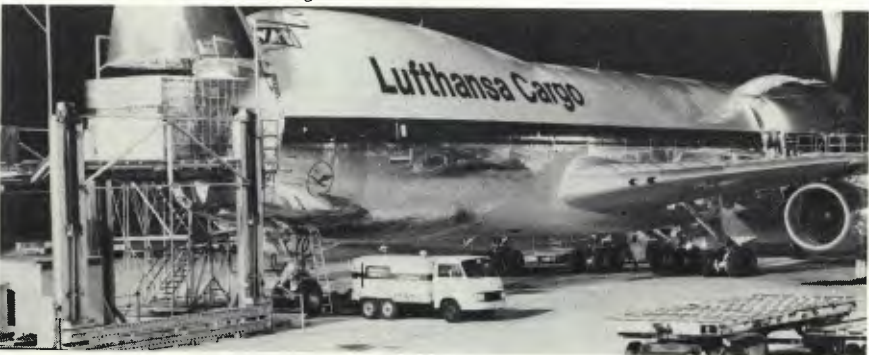
O 1º corpo-largo do mundo, aqui na versão carga: B 747 F, 99 t
