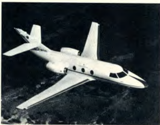
Falcon 10: bimotor executivo, tem velocidade-cruzeiro de 912 km/h.
