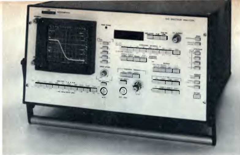
O analisador digital de espectro, modelo 1510 da E MR-Instruments tem tolerância até 2.048 gradações
