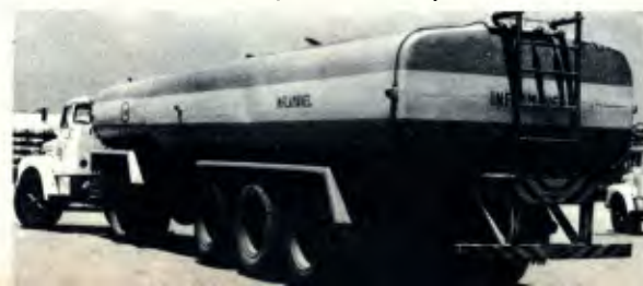
Biselli e Clark: alumínio para reduzir o peso do veículo.
