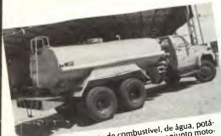
**Tanques:** Para transporte de combustível, de água, potável ou não, podendo ser equipado com conjunto motor-bomba de diversas capacidades de vazão e pressão.
