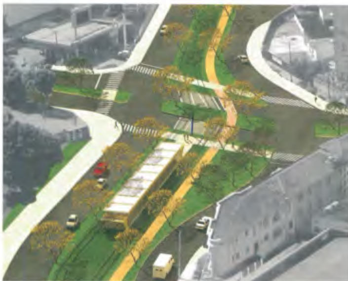
Projeto da Estação Ana Costa do VLT a ser implantado na cidade de Santos, litoral paulista, um sistema que convive no tráfego com outros meios de transporte
