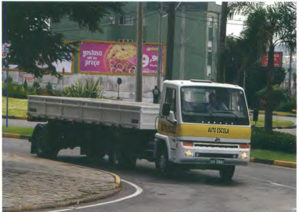
O Agrale 8500 TR tem peso bruto total de 8.000 kg e entre-eixos de 2.920 mm
