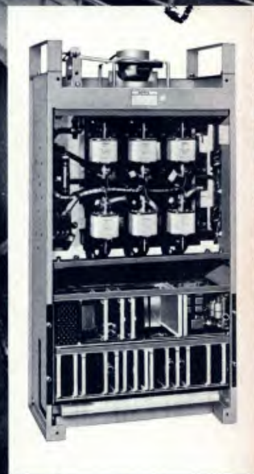
Aparelho SIMOREG. Este é o conversor estático tiristorizado com regulação eletrônica de corrente e velocidade, que oferece precisão, rentabilidade e segurança no acionamento de pontes rolantes.
