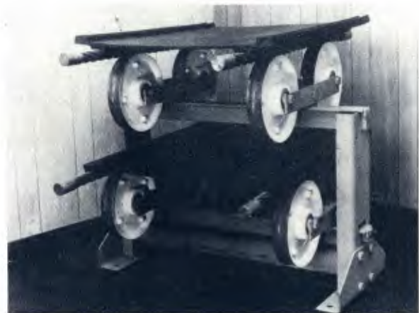
Módulo da correia transportadora da Cable Belt
