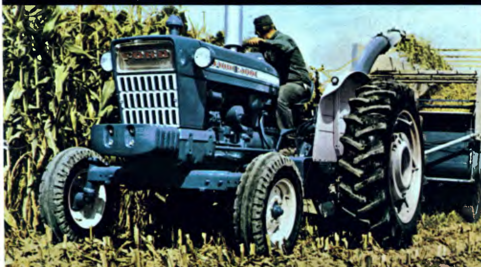
Trator agrícola FORD, modelo 5.000 de 77,1 HP. Diesel, com levante hidráulico de 3 pontos e tomada de força de 540 rpm.
