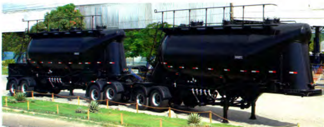
Silo em alumínio para transportar cimento, cal e areia, da Kronorte
