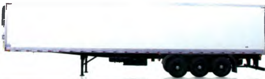
Semi-reboque paleteira-gancheira, da Boreal: transporte refrigerado em ganchos ou pallets
