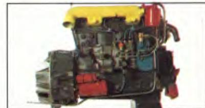
Motor Diesel de 4 tempos e injeção direta. Tem 4 cilindros em linha, com 4.941 cm<sup>3</sup>; potência de 97 CV (SAE) ou 90 CV (DIN) a 2.400 r.p.m. e torque máximo de 33,5 kgm (SAE) ou 31 kgm (DIN) a 1.400 r.p.m. Serve?
