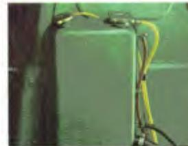
Reservatório extra de água, atrás da cabine, para evitar folhas e evaporação prematura no sistema de arrefecimento. A temperatura do motor é sempre normal debaixo do sol brasileiro.
