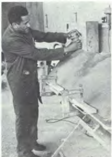
A Borlenghi tira o de chapa, corroído, e põe o de fibra, feito em casa
