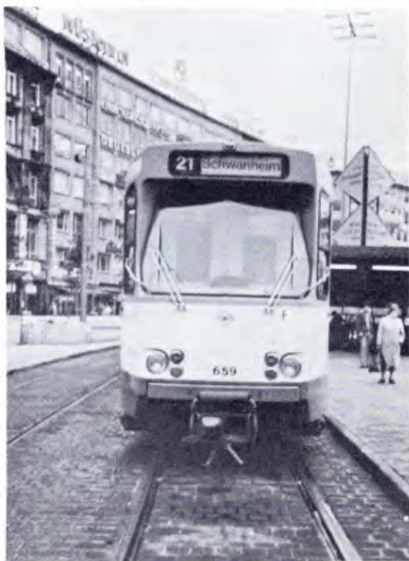
Em Frankfurt, circulam modernos VLT de dupla articulação, fabricados pela Duwag e equipados com motores elétricos Siemens.
