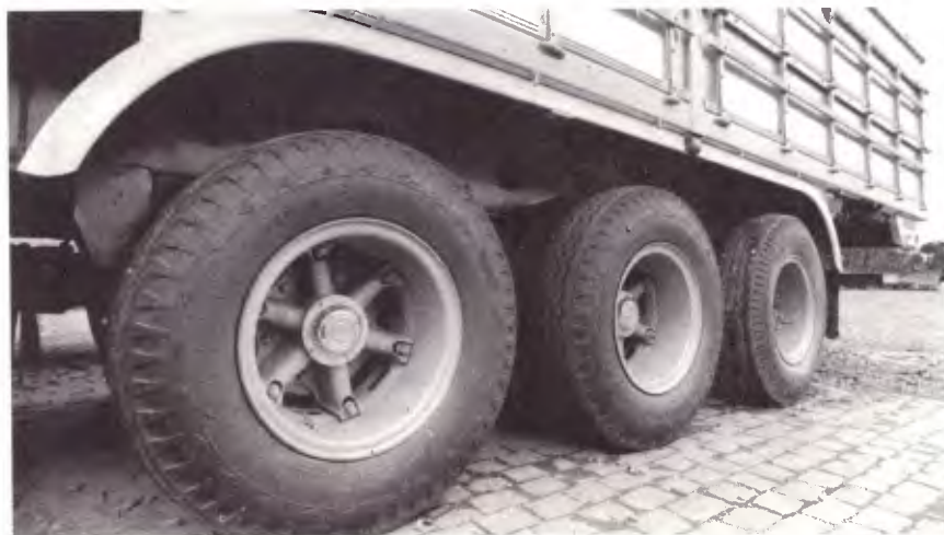
A tradicional suspensão com terceiro-eixo móvel continuará sendo usada.
