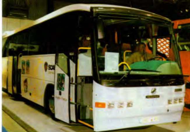
Scania L94 UB urbano possui motor DSC9 11, de 220 cv
