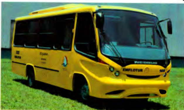
Micro Neobus: design futurista com frontal moldado em fibra de vidro
