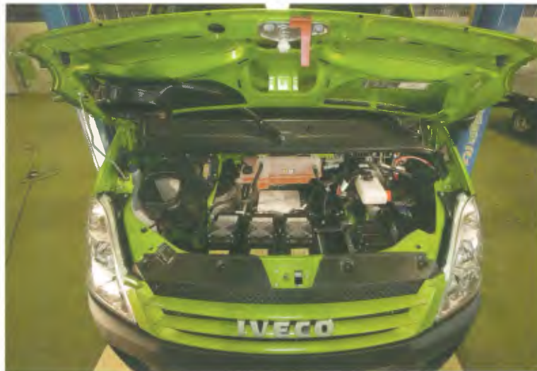
As três baterias do veículo elétrico têm vida útil de cerca de mil cargas
