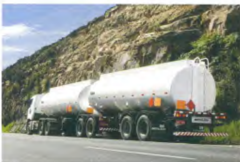
Bitrem MaxiTank da Metalesp: baixo centro de gravidade da carga aumenta estabilidade e segurança
