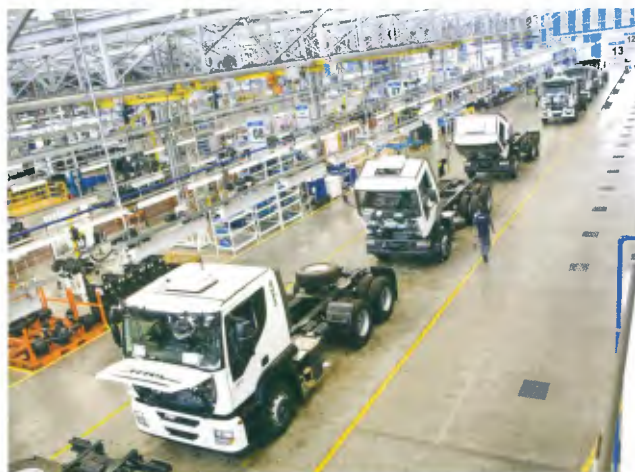
A montagem de cabines e de chassis em três linhas paralelas no galpão de 12 mil m 2 tem 39 estações de trabalho
