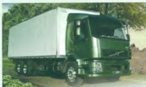
Série especial é formada por semipesados com motor de 260 cv e configuração 6x2
