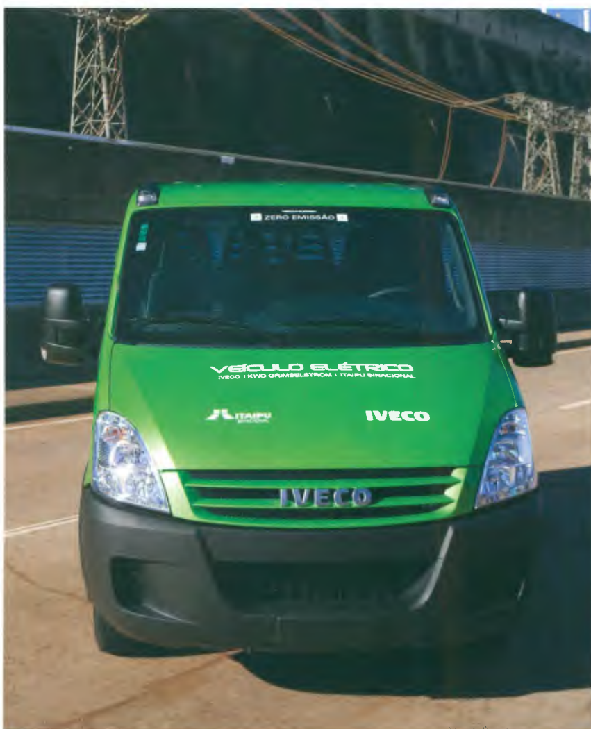
Daily elétrico montado em Itaipu tem autonomia de 100 km e velocidade de até 80 km/h
