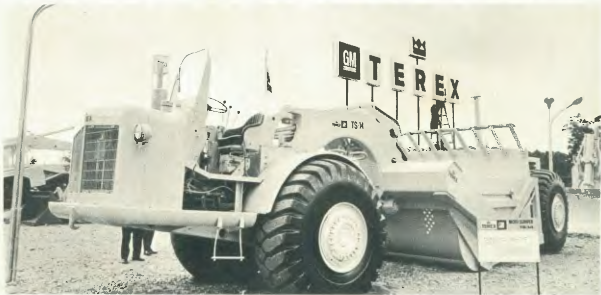
Motoscraper: de acordo com o Projeto de Terminologia Brasileira 51, um escavo-transportador motorizado.
