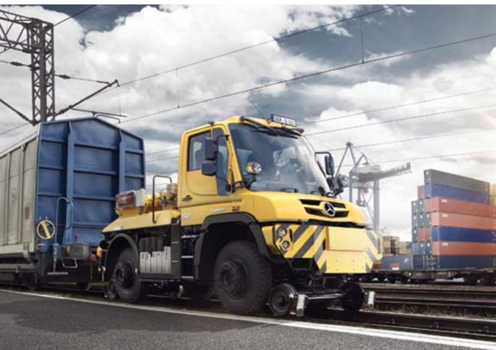
Misto de caminhão e locomotiva, Unimog pode puxar composição de até 140 vagões
