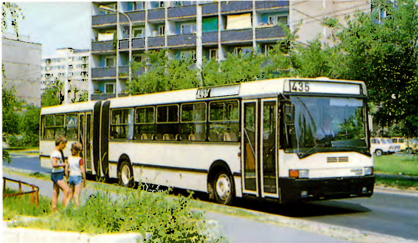
Articulado Ikarus modelo 435: 18 m de comprimento, entre-eixos de 5,57 m e 6,40 m e caixa Voith com opção de ZF
