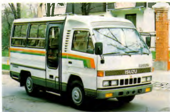
Micro Ikarus/Isuzu: motor de 4 cilindros, estrutura de aço tubular e capacidade para 14 passageiros
