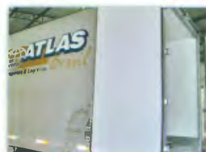
Adaptação de baús e semi reboques secos para isotérmicos (refrigeríficos)
