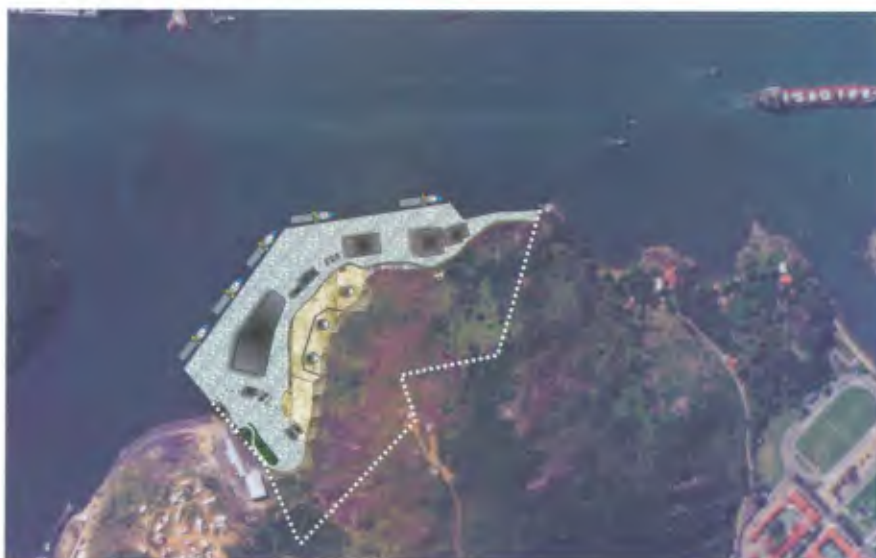
Com 90.000 m 2 de área, o terminal terá uma estrutura de tancagem para 50 milhões de litros de granéis líquidos
