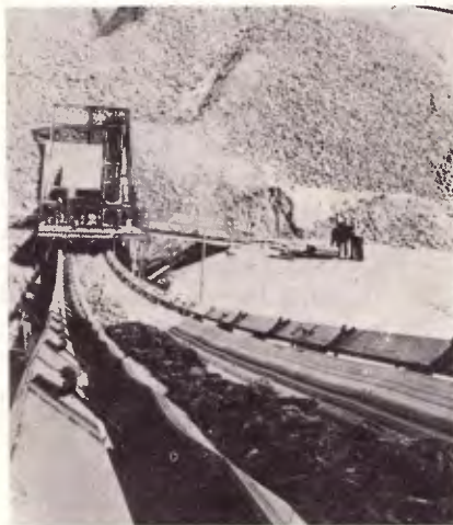
O cabo torna a correia mais resistente.
