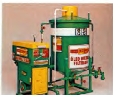
Este é o Dieselimpô modelo Master para tanques enterrados, conhecido, também, como o filtra-tudo.
