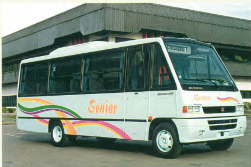
Modelo: Senior GV Aplicações: urbano, escolar, turismo Estrutura: aço galvanizado Comp.: 6.600 mm e 8.085 mm Larg.: 2.240 mm Altura total: 2.780 mm Capacidade/passageiros: 16/29 Chassis que podem ser encarroçados: Agrale, Ford, MBB, VW
