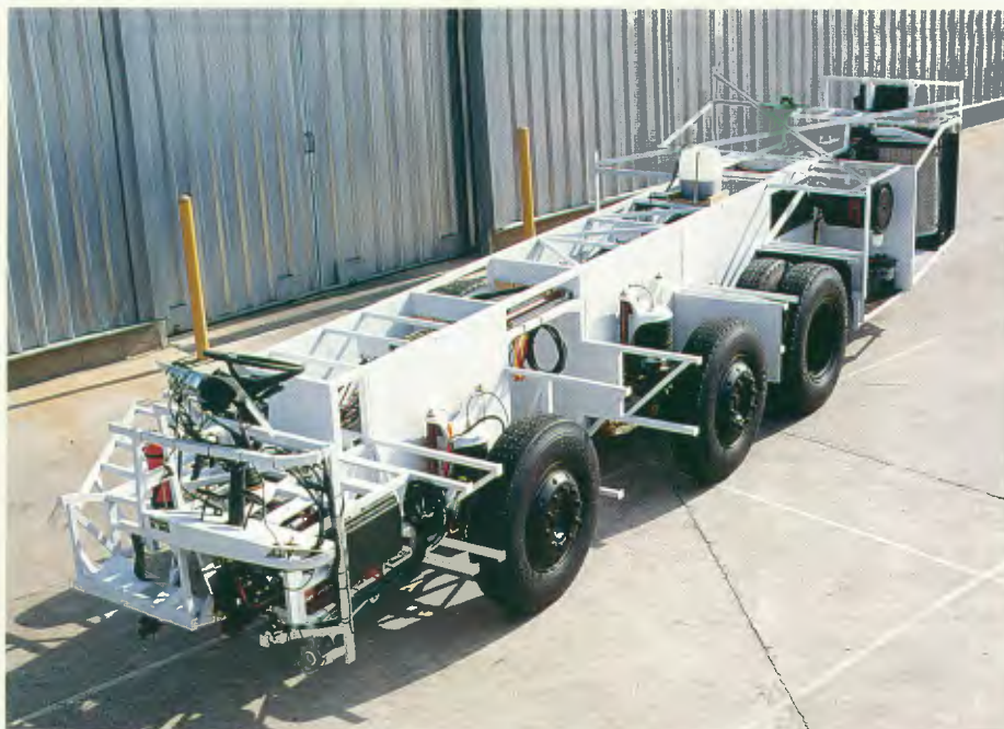
Modelo: O-400 RSD Plataforma alongável Aplicações: rodoviário Tração: 6x2 Motor: OM-477 LA, 360 cv Entre-eixos.: 2.213 mm + 1.480 mm Suspensão: pneumática Peso vazio: 6.930 kg Peso bruto - eixo dianteiro: 6.500 kg Peso bruto - eixo traseiro: 18.000 kg Peso bruto total: 24.500 kg
