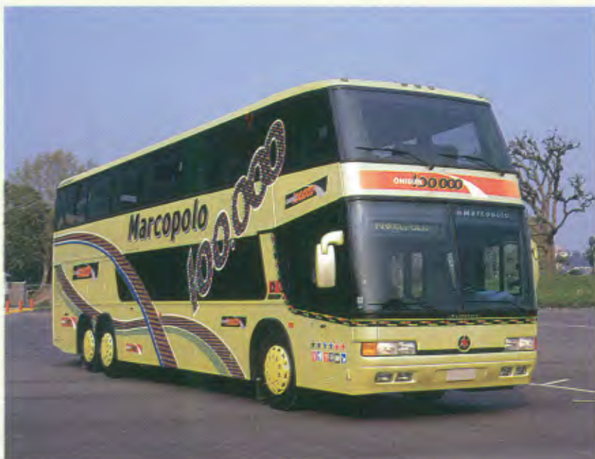
Modelo: Paradiso 1800 Double Decker Aplicações: rodoviário Estrutura: aço galvanizado Comp.: 13.200 mm a 14.000 mm Larg.: 2.600 mm Altura total: 4.100 mm Capacidade/passageiros: 37/71 Chassis que podem ser encarroçados: MBB, Scania e Volvo.
