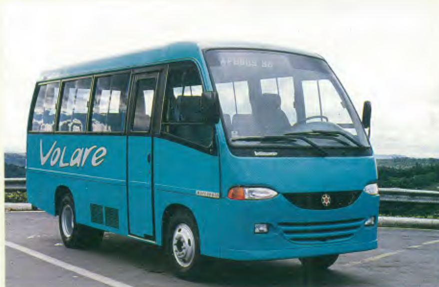
Modelo: Volare Aplicações: executivo/turismo Estrutura: aço galvanizado Comp.: 6.400 mm Larg.: 2.040 mm Altura total: 2.700 mm Capacidade/passageiros: 16/23 Chassis que podem ser encarroçados: exclusividade Marcopolo
