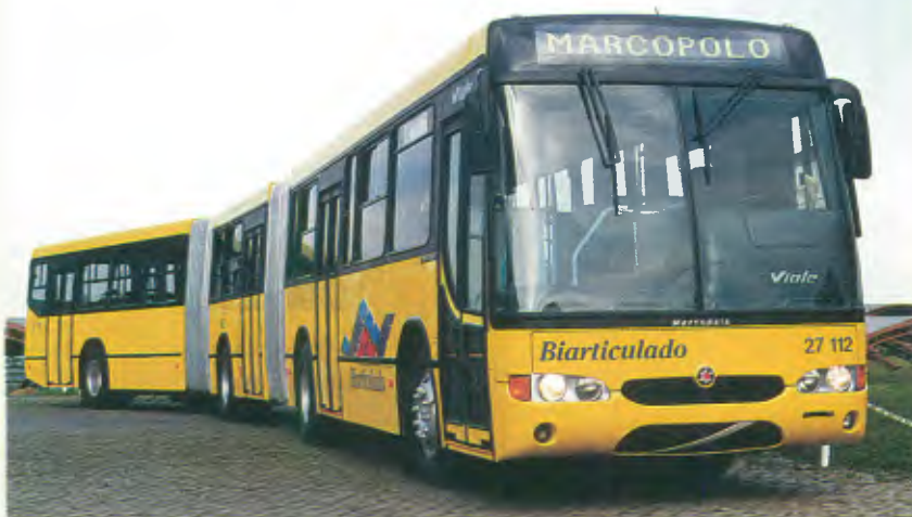
Modelo: Viale Bi-articulado Aplicações: urbano Estrutura: aço galvanizado Comp.: 24.445 mm Larg.: 2.500 mm Altura total: 3.100 mm Capacidade/passageiros: 274 Chassis que podem ser encarroçados: Volvo.
