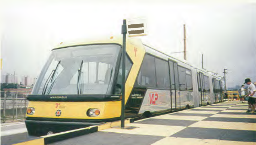
Modelo: VLP (Fura-Fila) Aplicações: urbano Estrutura: aço galvanizado Comp.: 24.750 mm Larg.: 2.500 mm Altura total: 3.500 mm Capacidade/passageiros: 225 Chassis que podem ser encarroçados: Volvo.
