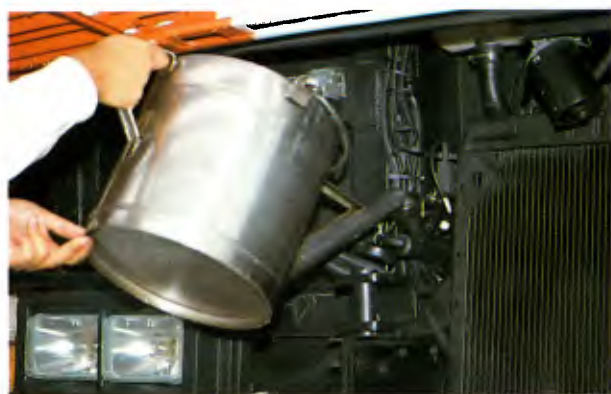
Óleo de cárter pela frente: reduz tempo e sujeira
