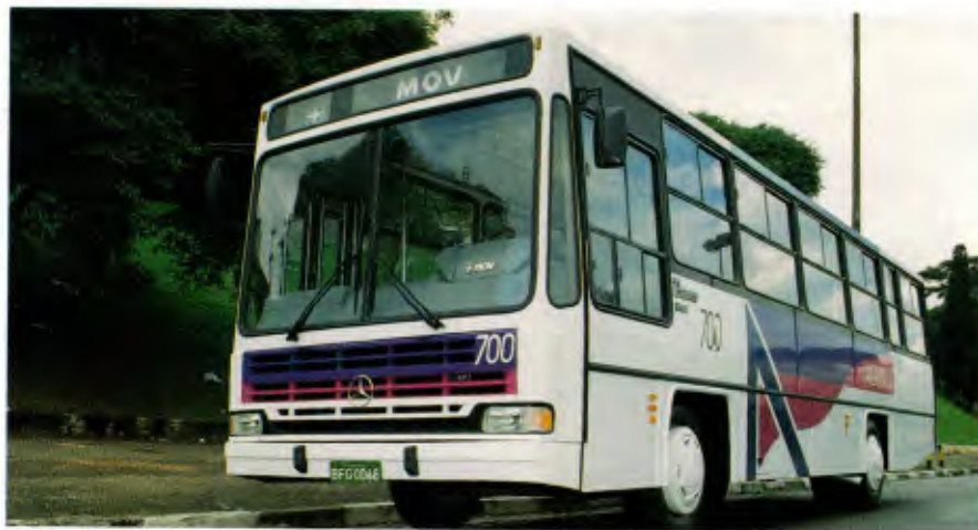
O Passeo tem pára-brisa fabricado em vidro bipartido
