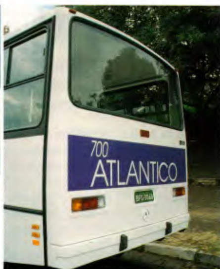
Porta de duas folhas do tipo envolvente e traseira em fibra de vidro
