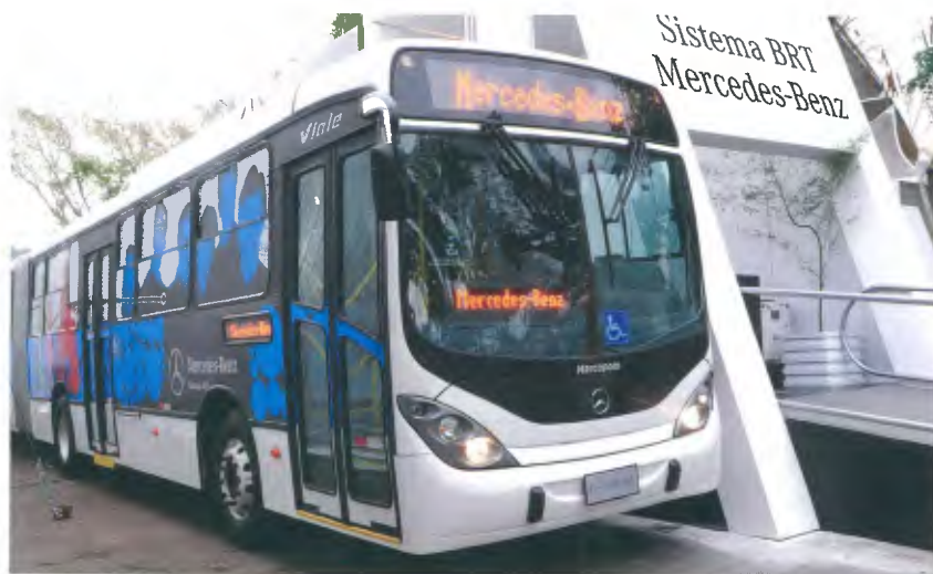
Protótipo do ônibus articulado O 500 MA com motor BlueTec 5 SCR, tecnologia em desenvolvimento para atender a legislação Conama P7
