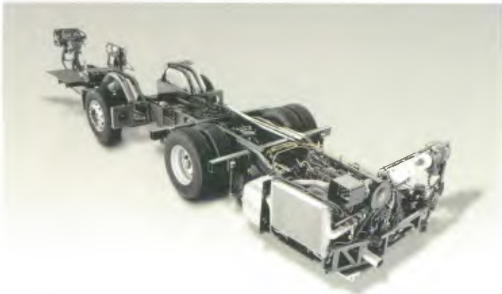
Modelo: L94 UB 4x2 LB Aplicações: Urbano Motor: DC9 01, 230 cv Suspensão: Pneumática PBT técnico: 19.100 kg
