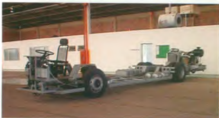
Modelo: OA 105 Low Floor Aplicações: Urbano Super Baixo Tração: 4x2 Motor: Cummins 6CTAA 8.3, 208 cv Entre-eixos: 5.980 mm, 6.800 mm Suspensão: Pneumática Peso bruto-eixo dianteiro: 7.264 kg Peso bruto-eixo traseiro: 10.500 kg Peso bruto total: 17.764 kg
