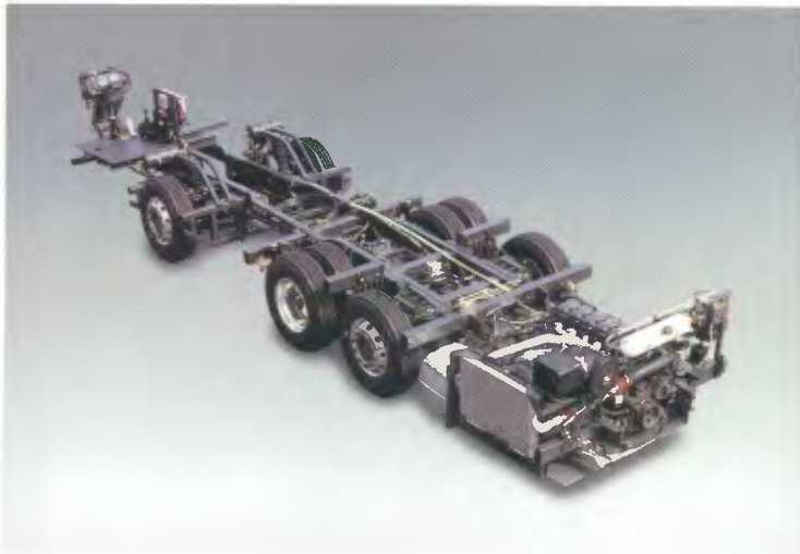
Modelo: K124 EB 6x2 NI Aplicações: Rodoviário Motor: DSC12 02, 360 cv, DSC12 05, 420 cv Suspensão: Pneumática PBT técnico: 25.000 kg
