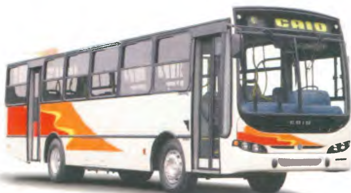
Modelo: Apache S21 Aplicações: Urbano Estrutura: Aço Comp.: 12.100 mm Larg.: 2.500 mm Altura total: 3.350 mm Chassis que podem ser encarroçados: Mercedes-Benz, Volkswagen, Agrale
