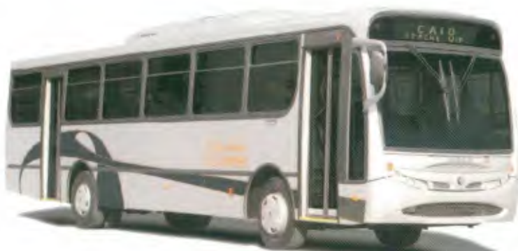
Modelo: Apache VIP Aplicações: Urbano Estrutura: Aço Comp.: 12.120 mm Larg.: 2.500 mm Altura total: 3.350 mm Chassis que podem ser encarroçados: Volkswagen, Mercedes-Benz, Scania, Volvo
