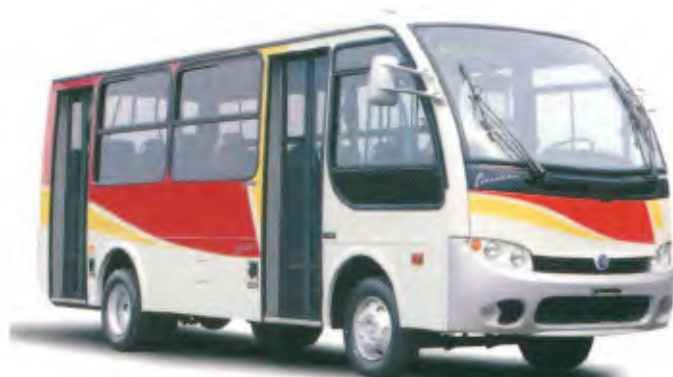
Modelo: Piccolino Aplicações: Urbano Estrutura: Aço Comp.: 7.495 mm Larg.: 2.100 mm Altura total: 2.800 mm Chassis que podem ser encarroçados: Volkswagen, Mercedes-Benz
