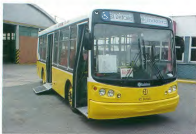
Modelo: OA 106 LE Aplicações: Urbano Low Entry (Midibus) Tração: 4x2 Motor: Cummins 6BTAA 5.9, 160 cv, Cummins ISB, 185 cv Entre-eixos: 4.650 mm Suspensão: Pneumática Peso bruto-eixo dianteiro: 4.100 kg Peso bruto-eixo traseiro: 6.800 kg Peso bruto total: 10.900 kg
