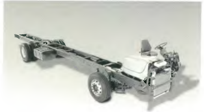
Modelo: F94 HB 4x2 Aplicações: Urbano Motor: DC9 01, 230 cv Suspensão: Mecânica PBT técnico: 19.500 kg
