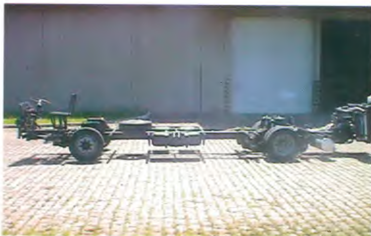
Modelo: OA 106 Aplicações: Urbano (Midibus) Tração: 4x2 Motor: Cummins 6BTAA 5.9, 160 cv, Cummins ISB, 185 cv Entre-eixos: 4.650 mm Suspensão: Pneumática Peso bruto-eixo dianteiro: 4.100 kg Peso bruto-eixo traseiro: 6.800 kg Peso bruto total: 10.900 kg
