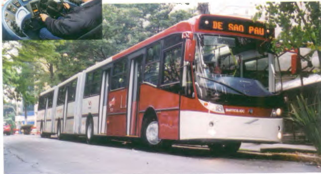
Novo biarticulado Volvo/Induscar, com posto central de direção e 27 metros de comprimento
