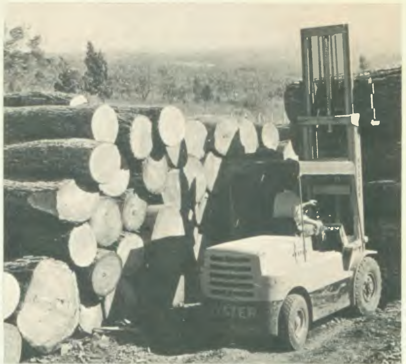
A rodagem é determinada em função do terreno onde irá operar a máquina.
