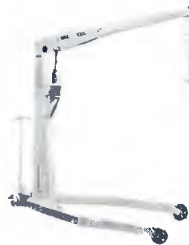
128/HE Guindaste Hidráulico Carga: 1000 - 800 - 600 - 400 - 200 kg Lança extensível = 160 a 240 cm
