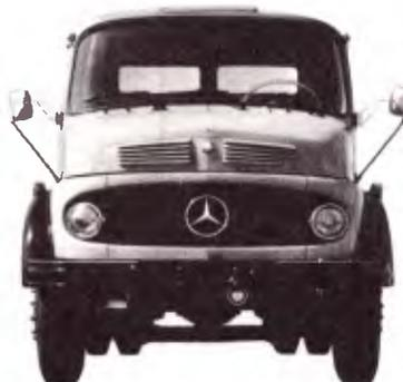
*LK-1313 - Chassi de caminhão médio-pesado, com tomada de força. Peso bruto total: 12500kg. Distância entre eixos: 3600mm.*
