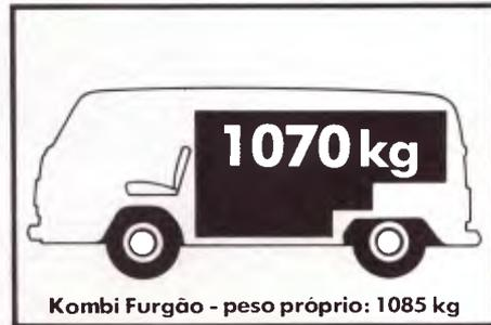
Os detalhes de construção de todas as versões da Linha Kombi, especialmente a posição da cabina, permitem maior aproveitamento do compartimento de carga, possibilitando uma distribuição homogênea do peso sobre os eixos.
