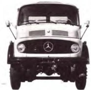
**L-2213 6 x 2** - Chassi de caminhão médio-pesado, com dois eixos traseiros em tandem, o primeiro deles motriz. Peso bruto total: 21000kg. Distâncias entre eixos: 3600mm + 1300mm; 4200mm + 1300mm; 4823mm + 1300mm.
