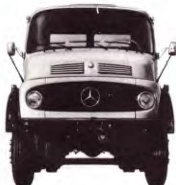
**LB-2216 6 x 4** - Chassi de caminhão médio-pesado para betoneiras, com tomada de força na polia antivibradora do motor, dotado de dois eixos traseiros em tandem, ambos motrizes. Peso bruto total: 22000kg. Distância entre eixos: 3600mm + 1300mm.
