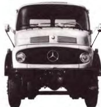
**LK-2213 6 x 4** - Chassi de caminhão médio-pesado, com tomada de força, dotado de dois eixos traseiros em tandem, ambos motrizes. Peso bruto total: 22000kg. Distância entre eixos: 3600mm + 1300mm.
