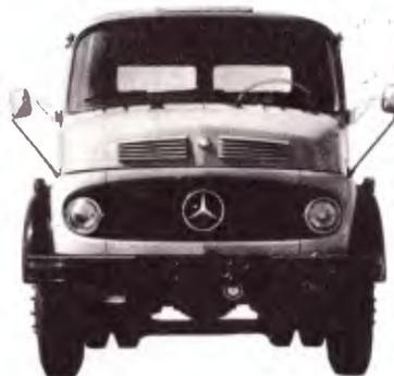
*LS-1316 - Chassi de caminhão-tractor médio-pesado. Capacidade máxima de tração: 25000kg. Distância entre eixos: 3600mm.*
