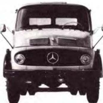
*LK-1316 - Chassi de caminhão médio-pesado, com tomada de força. Peso bruto total: 12500kg. Distância entre eixos: 3600mm.*
