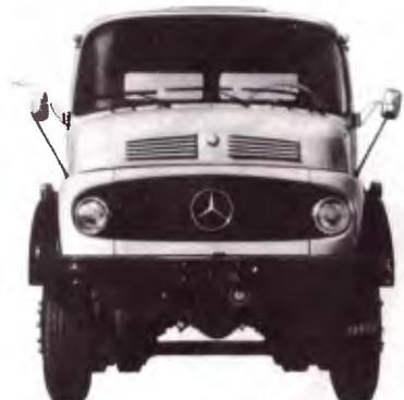
**L-2216 6 x 4** - Chassi de caminhão médio-pesado, com dois eixos traseiros em tandem, ambos motrizes. Peso bruto total: 22000kg. Distâncias entre eixos: 3600mm + 1300mm; 4200mm + 1300mm.
