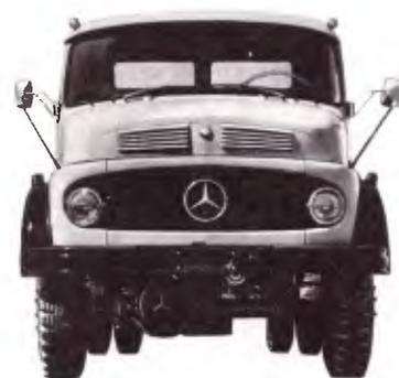
*LAS-1113 4 x 4 - Chassi de caminhão-tractor médio, com tração total. Capacidade máxima de tração: 19000kg. Distância entre eixos: 3600mm.*
