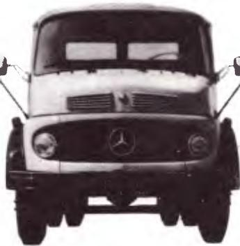
*LS-1113 - Chassi de caminhão-tractor médio. Capacidade máxima de tração: 19000kg. Distância entre eixos: 3600mm.*
