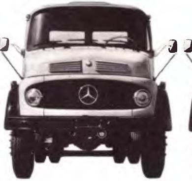
**LK-1513** - Chassi de caminhão médio-pesado, com tomada de força. Peso bruto total: 15000kg. Distância entre eixos: 4200mm.
