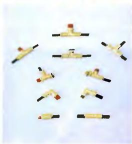
Conexões para o uso com a maioria dos tubos termoplásticos desenvolvida para circuitos pneumáticos de baixa pressão, onde a montagem e desmontagem do tubo é ágil e não requer ferramenta de aperto, bastando inserir o tubo até o fundo da conexão para conectar, e pressionar a pinça contra a conexão e puxar o tubo para desconectar.
