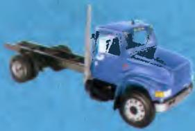
A concepção do chassi é uma das grandes vantagens. Longarinas em "U" com reforço total em "L" desde a suspensão dianteira até a traseira. São retas e desobstruídas, proporcionando fácil montagem de carrocerias dos mais variados modelos, o que permite economia nos custos de adaptação.
