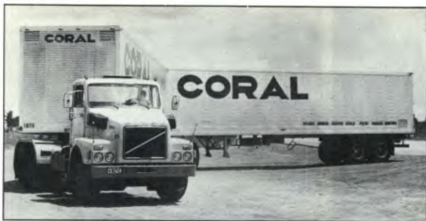
Graças à reduzida dimensão do dolly, o raio de giro é bem pequeno.
