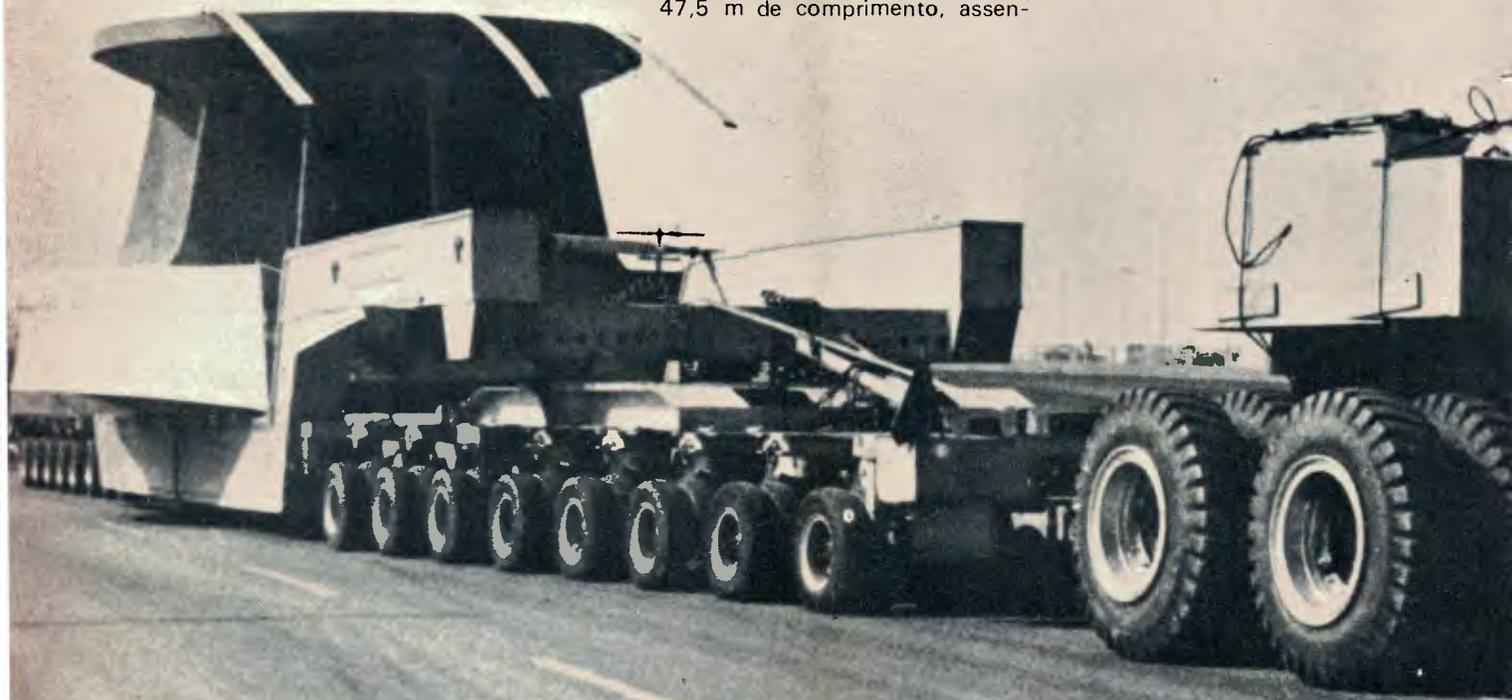
Carreta de treze eixos transportando uma turbina de 136 t para a CESP.
