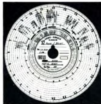
Coloque o disco-diagrama no Tacógrafo KIENZLE e fique tranquilo. A cada 24 horas ou 7 dias, V. saberá com precisão tudo o que ocorreu com seus veículos: velocidades atingidas, tempos de marcha e paradas, distâncias percorridas e regime de trabalho do motor. Há quatro modelos de Tacógrafo KIENZLE. Todos com garantia e assistência técnica permanente e comprovada.
